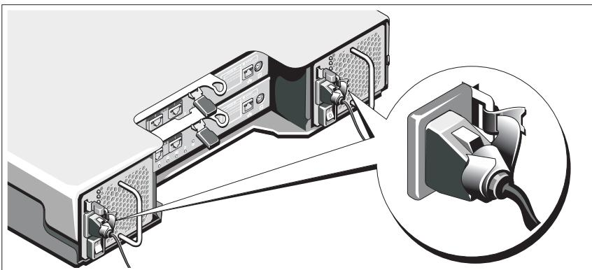
Befestigen Sie die Kabel fest mit der Halterung, und verwenden Sie dazu das mitgelieferte Band.
