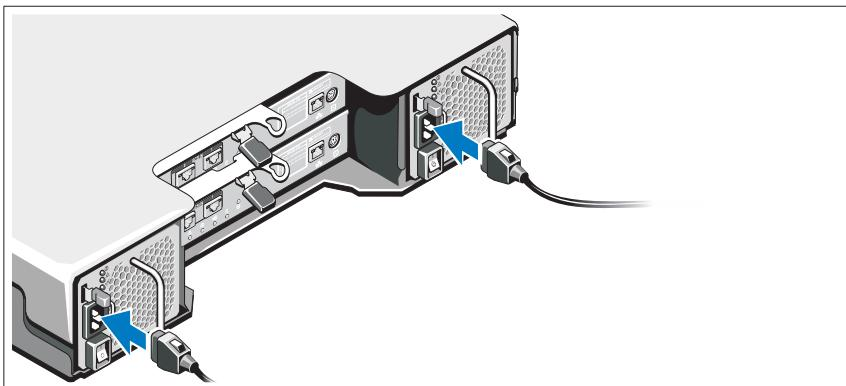
Asegúrese de que el interruptor de alimentación esté en la posición de APAGADO antes de conectar los cables de alimentación. Conecte los cables de alimentación del sistema al sistema.
