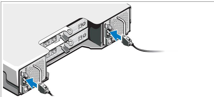
Upewnij się, że przycisk zasilania znajduje się w położeniu wyłączony przed przystąpieniem do podłączania kabli zasilania. Podłącz kable zasilania do systemu.
