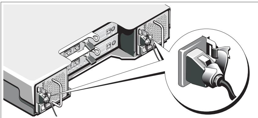
Pomocí řemínku pevně připevněte kabely k držáku.
